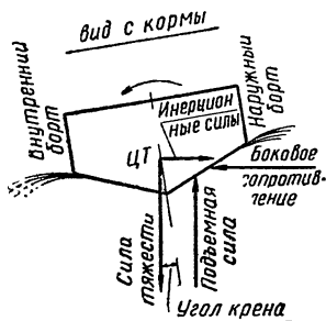
Рис. 49. Расположение сил при повороте глиссирующего судна
